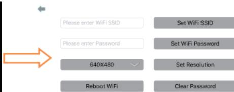
**Nota 1:** Si no es necesario, no lo aconsejamos a nuestros clientes el cambio del SSID WiFi original y contraseña WiFi para la experiencia de uso más estable. Si se le olvidó la contraseña modificada, utilice un clip para presionar el agujero de restablecer y luego reinicie el endoscopio y re-
